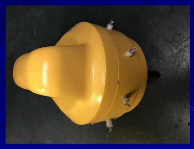
INSIDE THE NEON LAMPS ARE WIRED TO THE INDIVIDUAL BLADES OF THE CAMCO PLUG. THE VOLTAGE DROPPING RESISTORS FOR THE NEON LAMPS ARE ALREADY ATTACHED
